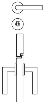
Sicherheitsdrücker in U-Form aus farbigem Nylon, Aluminium oder Edelstahl mit Schauscheibe und Metallvierkant als Notentriegelung.
