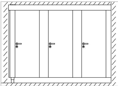
**Hängende Ausführung** ohne FüÙe mit Trägerprofil 50 x 150 mm
